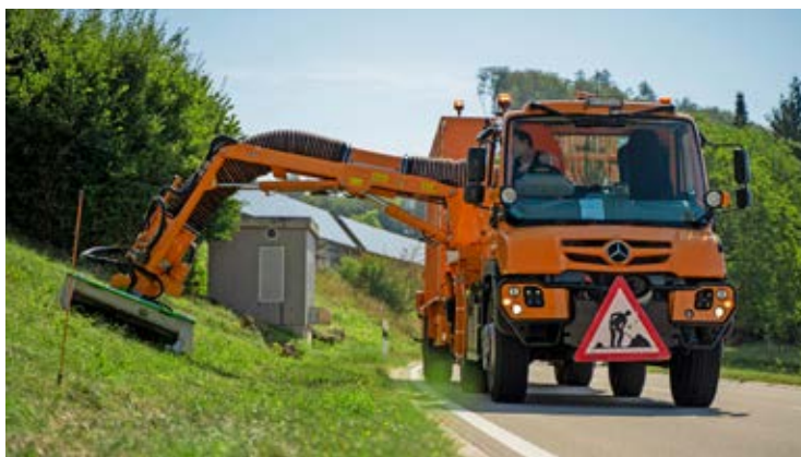
Falciatrice Mulag Eco 1200 plus del Dipartimento di manutenzione stradale del Cantone di Argovia durante lo sfalcio.
